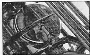
G/G sharp/B flat adjusting arm: A better balance between left hand and right hand regulation. Correspondance Sol/Sol # / Si b : un meilleur équilibre du réglage main gauche/main droite.
